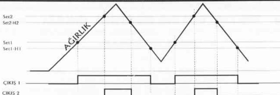
İki noktada ON-OFF tipi kontrol yapan tipi ağırlık ölçüm ve kontrol cihazının çalışma şekli, hysteresis değerleri de göz önüne alınarak yukarıda graflık ile gösterilmiştir.
